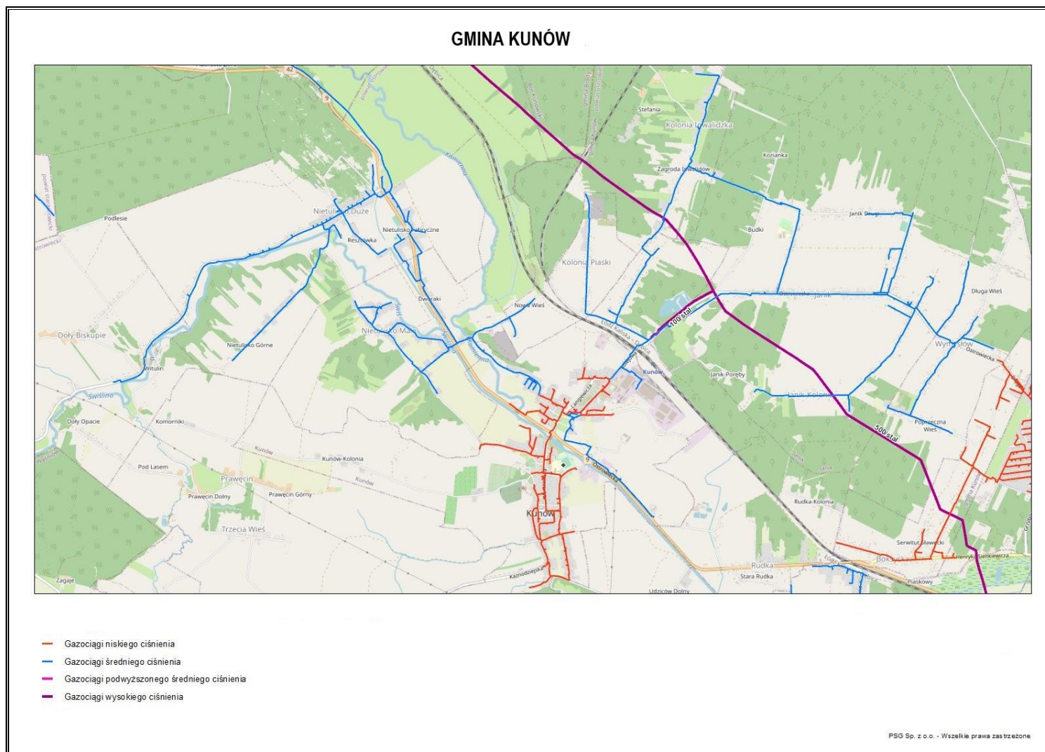
Rysunek 9. Schemat sieci gazowej na terenie miasta i gminy Kunów
